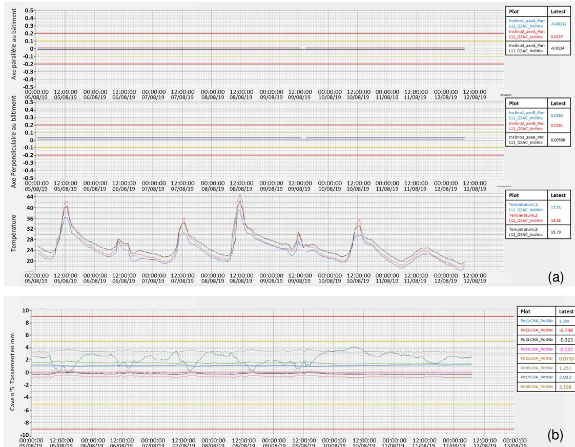
Figure 23. Mesures inclinométriques (a) et des cibles de nivellement sur structures des bâtiments (b).
